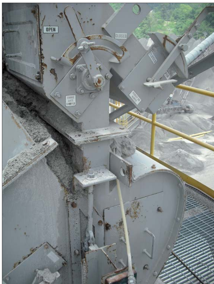
Vue de côté d'un classificateur, avec réglage manuel des clapets d'admission d'air. Il est semblable à ceux qui seront mis en service chez Cimescaut Matériaux, sauf que ces derniers auront un débit d'air et un débit matière modulables depuis le synoptique de l'installation
